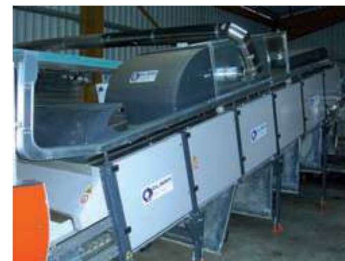
Drying Tunnel Tunnel di Asciugatura
